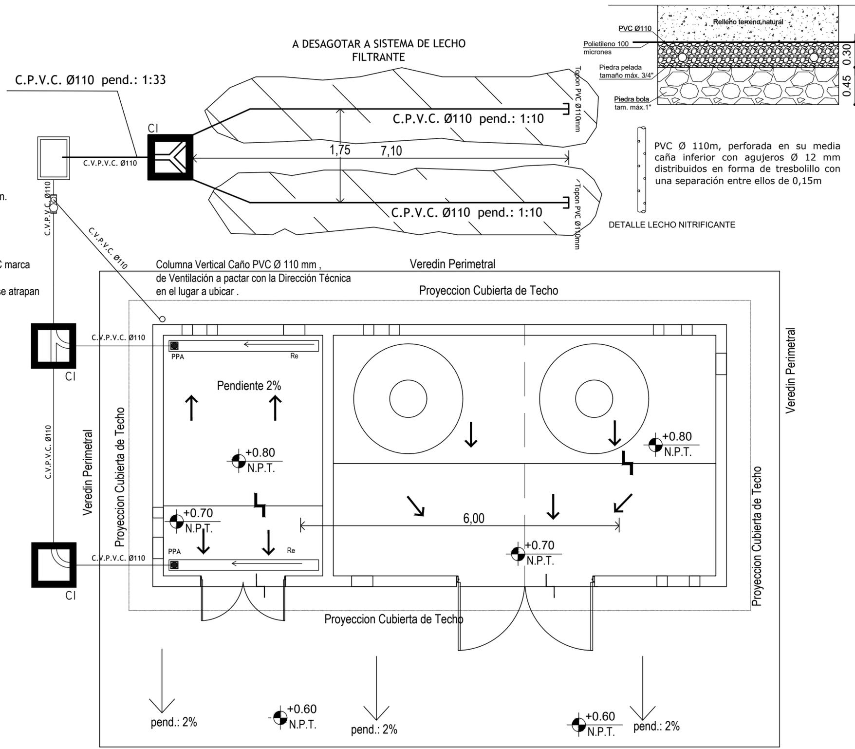
Trampa para Grasas , marca Durman. Modelo 35 GPM , PVC . Ø ingreso y salida 110mm
